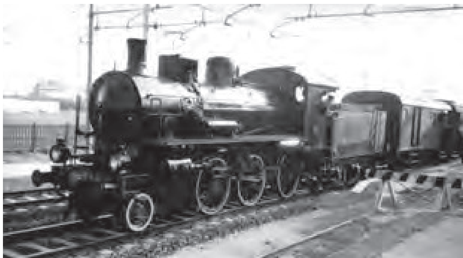
Locomotiva che si incontrava frequentemente sulla nostra linea ai tempi del vapore»: gruppo 625 FS, costruita tra il 1910 ed il 1923, adibita prevalentemente al traino degli accelerati leggeri ed anche dei merci. L'esemplare qui ritratto, fermo a Forlimpopoli, sta effettuando il Treno delle Castagne, nell'ottobre 2001, alla guida di un macchinista d'eccezione, l'Ing. F. Pirazzini, allora Dirigente F.S. (foto De Giorgio)
