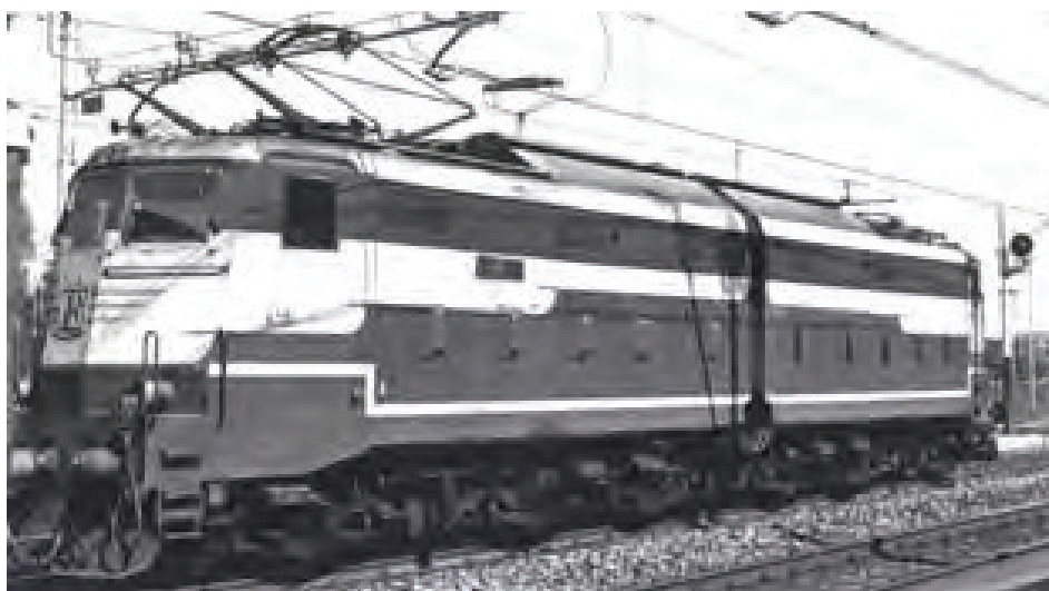
Locomotore elettrico E 646 005, anno 1960 c.a., caratteristico per la coloritura grigio-verde, ritratto nel 1979 a Forlimpopoli, mentre traina un locale per Rimini, composto dalle famose vetture centoporte. Questa unit  l'ultima della preserie: infatti la serie successiva avr  un muso squadrato e sostanziali modifiche elettriche e meccaniche. Oggi non se ne vedono transitare pi  sulla Bologna-Rimini, anche se qualche esemplare risulta ancora in servizio (foto Asirelli)
