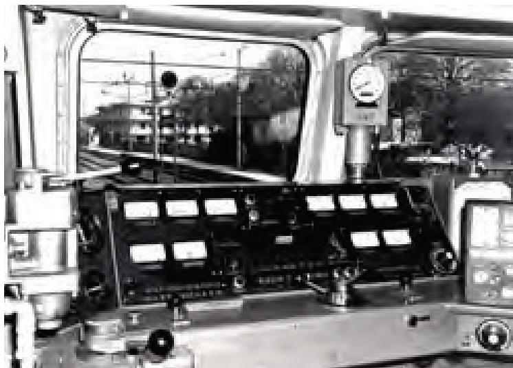
La stazione di Forlimpopoli vista dalla cabina di guida di una E 656, verso Rimini (in fondo si vede ancora il P.L. della strada di S. Andrea, oggi soppresso). Al centro la strumentazione elettrica e le maniglie, assai ridotte, per la scelta del senso di marcia e l'avviamento e la regolazione della velocità. In alto il tachigrafo registratore della velocità, a destra le apparecchiature di ripetizione segnali, a sinistra i comandi dei freni (foto Asirelli)
